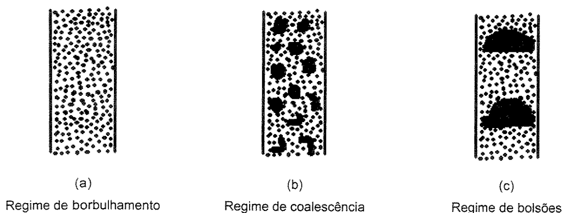
Figura 3 – Regimes de operação num reator de leito fluidizado trifásico segundo FAN (1989)
